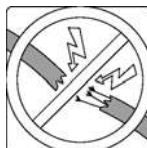
Zkontrolujte, zda nejsou kabely poškozeny.
